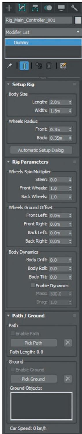
Im Rollout des DriverMaster-Kontrollobjekts kann das Fahrzeug manuell sowie über einen Pfad animiert werden.
